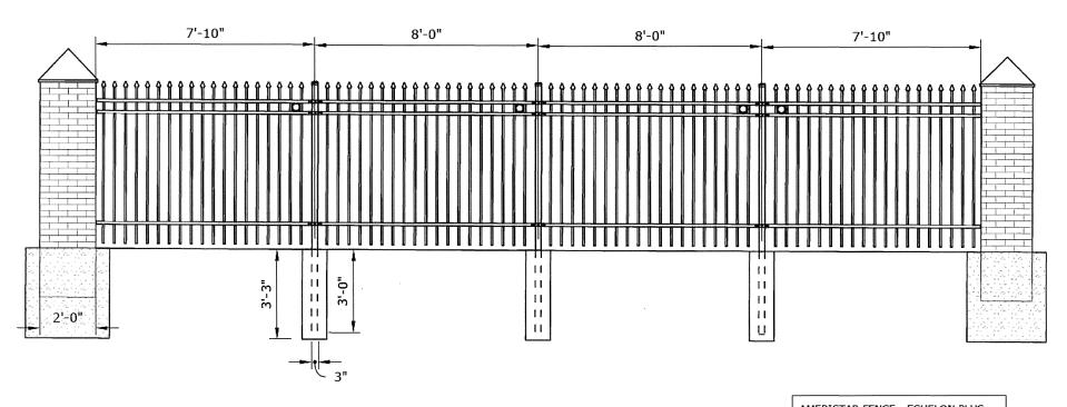
AMERISTAR FENCE - ECHELON PLUS GENESIS SERIES - 3 RAIL 6' FENCE HEIGHT - STANDARD BOTTOM
